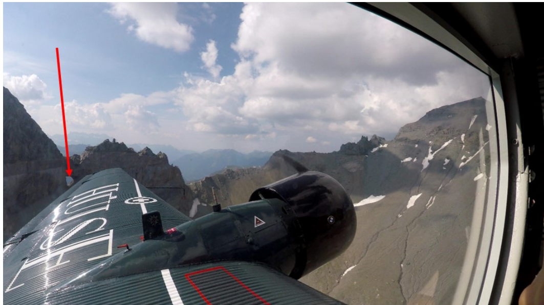
Abbildung 3: Standbild aus einer Videoaufnahme beim Punkt F10, aufgenommen aus dem Passagierraum der HB-HOT in Blickrichtung Martinsloch (roter Pfeil). Der Längslagewinkel beträgt 11.0^\circ , die Querlage nach links 4.8^\circ und die Höhe 2749 m/M. Die Differenz zwischen Flugbahnwinkel und Längslagewinkel beträgt 20.6^\circ .
