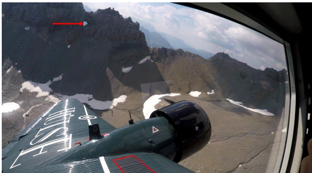
Abbildung 4: Standbild aus einer Videoaufnahme bei Punkt F13, aufgenommen aus dem Passagierraum der HB-HOT in Blickrichtung Martinsloch (roter Pfeil), 4.3 Sekunden nach der Aufnahme in Abbildung 3. Der Längslagewinkel beträgt 12.1^\circ , die Querlage nach links 32.7^\circ und die Höhe 2724 m/M.
